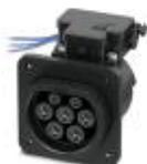
Infrastruktur-Ladedose, Rückseitige Schutzdeckelverschraubung, Zum Laden mit Wechselstrom (AC) von Elektrofahrzeugen (EV), Kompatibel zu Infrastruktur-Ladesteckern, Typ 2, IEC 62196-2, 32 A / 480 V (AC), Einzelladern, Länge: 0,7 m, Verriegelungsaktuator: 12 V, 4-polig, Rückwandmontage, Generation 1, PHOENIX CONTACT-Logo
