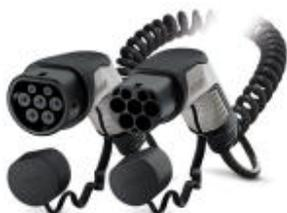
Mobile AC-Ladeleitung, Mit Fahrzeug-Ladestecker und Infrastruktur-Ladestecker, Mit Schutzkappen, Gehäusefarbe schwarz-grau, Zum Laden mit Wechselstrom (AC) von Elektrofahrzeugen (EV) mit Typ 2 Fahrzeug-Inlets, Kompatibel zu Typ 2 Infrastruktur-Ladedosen an Ladestationen für die Elektromobilität (EVSE), Typ 2, IEC 62196-2, 32 A / 250 V (AC), C-Line, PHOENIX CONTACT-Logo, Kabel: 4 m, schwarz, spiralisiert
