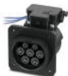
Infrastruktur-Ladedose, Rückseitige Schutzdeckelverschraubung, Zum Laden mit Wechselstrom (AC) von Elektrofahrzeugen (EV), Kompatibel zu Infrastruktur-Ladesteckern, Typ 2, IEC 62196-2, 32 A / 480 V (AC), Einzelladern, Länge: 0,7 m, Verriegelungsaktuator: 24 V, 4-polig, Rückwandmontage, Generation 1, PHOENIX CONTACT-Logo
